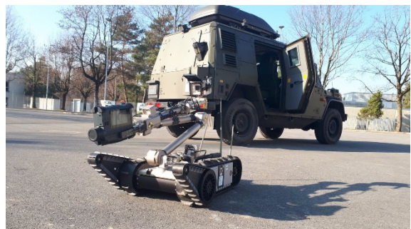
Abbildung 4 Mit einem tragbaren Radiometrie Gerät ausgerüsteter Roboter
